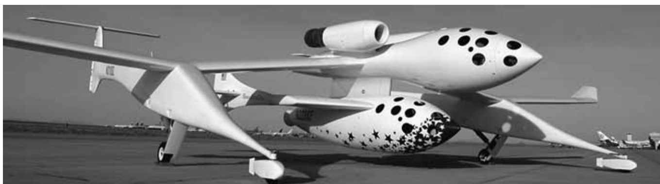
Het bemande SpaceShipOne voertuig dat door een vliegtuig gedropt moet worden, waarna het een hoogte van minstens 100 km moet bereiken. [Scaled Composites]
